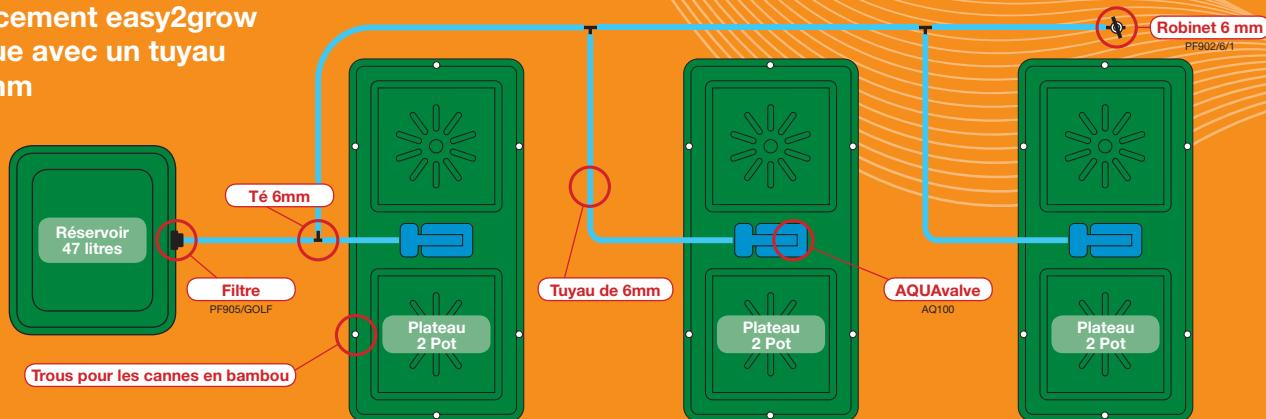
Le kit d'extension 2Pot se raccorde simplement au kit easy2grow en utilisant le tee 6mm inclus dans votre kit.
