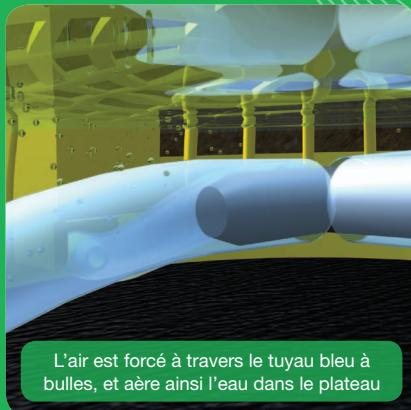
L'air est forcé à travers le tuyau bleu à bulles, et aère ainsi l'eau dans le plateau
