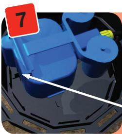
7 Cuando haya conectado la AQUAvalve a la tubería de 6mm, simplemente tire de la tubería hacia atrás a través del Top Hat Grommet de 6mm para que todo el exceso de tubería dentro de la AQUAbox Spyder salga hacia afuera. A medida que saque la tubería, baje la AQUAvalve para que se sitúe en la sección en T de la AQUAbox Spyder.
