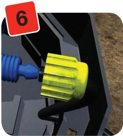
6 Ahora, la AQUAvalve podrá conectarse a la tubería de 6mm. Destornille el collarín amarillo y empuje la tubería a través de éste. Empuje la tubería de 6mm dentro de la boquilla de la AQUAvalve, y vuelva a colocar el collarín amarillo atornillándolo a la AQUAvalve.
