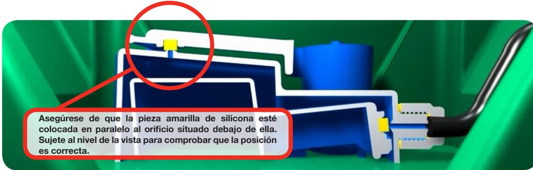
Asegúrese de que la pieza amarilla de silicona esté colocada en paralelo al orificio situado debajo de ella. Sujete al nivel de la vista para comprobar que la posición es correcta.
