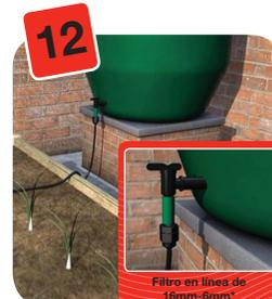
12 La imagen 12 muestra la AQUAbox Spyder conectada a un tanque de agua de 200 litros utilizando un filtro en línea de 16mm-6mm suministrado con su kit. Tome una tubería de 16mm o manguera estándar de 100mm de longitud...\*\*observe que esta tubería no se suministra con su kit\*\*...Instale la manguera en el grifo; seguidamente, conecte el filtro a la tubería, y a continuación, tome sus 2 metros de tubería de 6mm conectada a la AQUAbox Spyder y conéctala al otro extremo del filtro.
